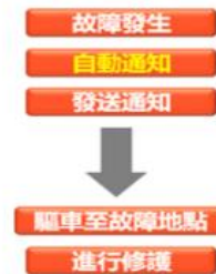
▲骨幹光纖監控系統 障礙通知及查修SOP
